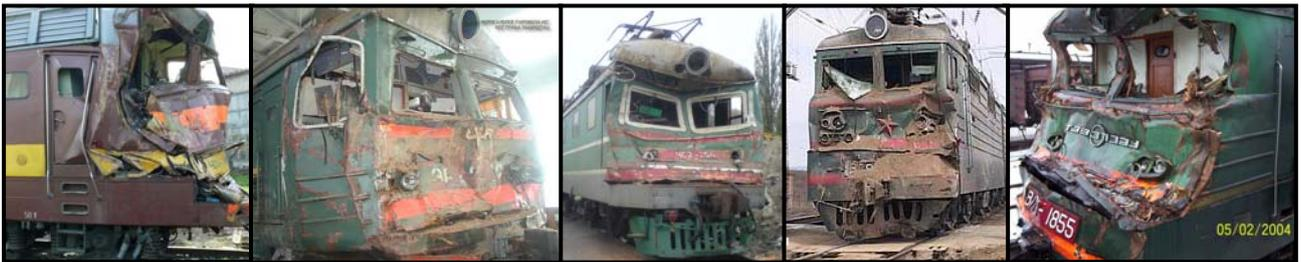
**Рисунок 1 – Вид лобовой части кузова после аварийного столкновения**
